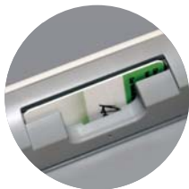
Verdeckter Heilberufsausweis gegen unbeabsichtigte Entnahme
